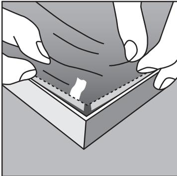
**An einer Ecke beginnend wird der Motivrand und die angenähte Gummilippe mit beiden Händen um 90° nach innen gedreht. Die Gummilippe ist somit nicht mehr erkennbar und wird in das U-Profil des Keder-Rahmens gedrückt.**
